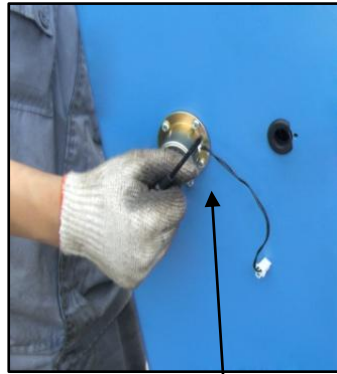
Elektromagnet an der Außenfläche der Säule
