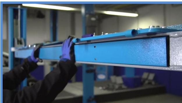
Wenden wir uns nun der Rückseite der Bühne zu. Hier wird der Entriegelungshebel montiert. Achten Sie jetzt darauf, die linke Stange nach oben auf die Gewindestange zu legen, um bei einer Drehung im Uhrzeigersinn zu entriegeln.
