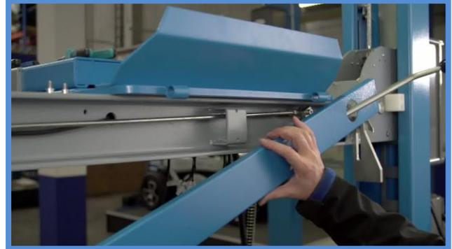
Bevor Sie nun die Innenabdeckungen wieder aufsetzen, kontrollieren Sie, dass alle Kabel sicher verlegt sind. Befestigen Sie diese nach Möglichkeit mit den mitgelieferten Kabelbindern, um Sie von beweglichen Teilen fern zu halten.
