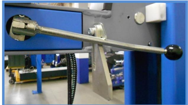
Zur Montage der Auffahrrampen entfernen Sie bitte die Seegeringe und ziehen Sie die Bolzen heraus. Anschließend bringen Sie die Auffahrrampen in Position, und setzen die Bolzen wieder ein.
