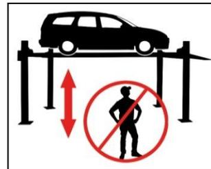
Der Aufenthalt von Personen (beim Heben oder Senken) unter der Hebebühne ist verboten!
