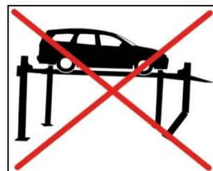
Beschädigte Hebebühne darf nicht in Betrieb genommen werden!
