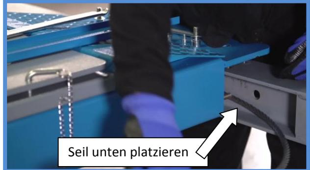
Achten Sie beim einfädeln der Seile darauf, dass diese später unter Spannung richtig geführt werden. Auf der Hauptseite mit dem Hydraulikzylinder müssen Sie darauf achten, dass das Stahlseil unter der Gewindestange durchgeführt wird.
