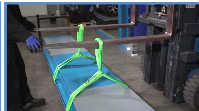
Nun können wir zum Schluss noch die rechte Fahrbahn entnehmen. Dazu bauen wir weitere zwei Stapel mit Paletten. Heben Sie die Fahrbahn leicht an und entfernen sie die Haltebolzen und danach die Transportgestelle.
