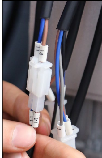
Abbildung: DOWN II - Kabel (2-adrig)
