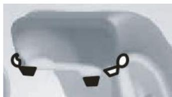
Wie bei Abb. 7-8 oder Abb. 7-9, bewegen Sie die Skala zur Innenposition der Felge, messen Sie den Innenabstand (aI)-Wert, und drücken Sie auf [a-] oder [a+], um den aI-Wert einzugeben.
