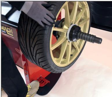
**IT** Con l'innovativo sistema di bloccaggio NLS che prevede la combinazione tra aria ed azoto al fine di migliorare la qualità del bloccaggio della ruota. Il sistema NLS si differenzia dai sistemi tradizionali di bloccaggio pneumatici perché sfrutta i vantaggi di un cilindro a circuito chiuso ad azoto. L'azoto non genera cali di pressione garantendo così una forza di serraggio costante.
