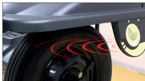
**IT** Con dispositivo sonar per la misurazione automatica della larghezza della ruota.
