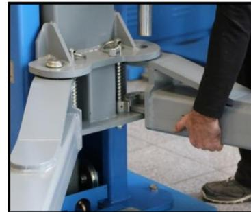
Abbildung 14: Montage der Tragarme am Hubschlitten
