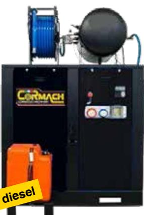
**IT** TMS 26" è disponibile anche nella versione già completa di generatore e compressore per un rendimento ottimale. Con avvolgitubo aria compressa e cabinet insonorizzato (Rumorosità solo 78dB).
