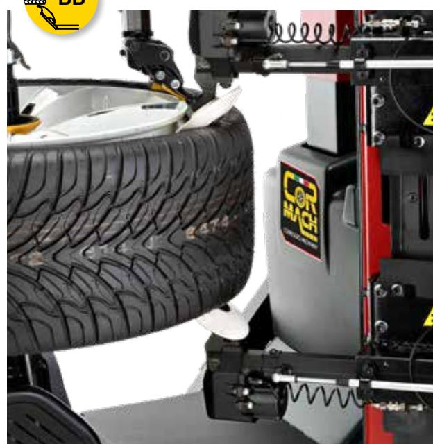
**IT** Stallonatura con doppio disco stallonatore sincronizzato (BB). Le operazioni di stallonatura avvengono in modo preciso e veloce grazie al movimento sincronizzato dei due dischi, controllato tramite console comandi multifunzione.
