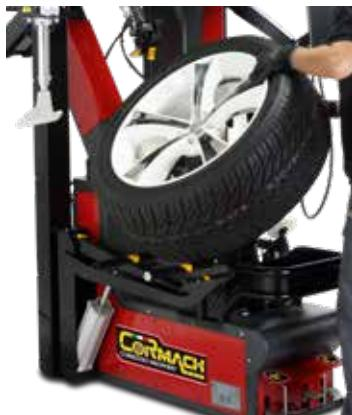
**IT** Dispositivo pneumatico per il sollevamento della ruota con comandi a pedale. Consente il corretto posizionamento sull'autocentrante di tutte le ruote, senza sforzo per l'operatore.
