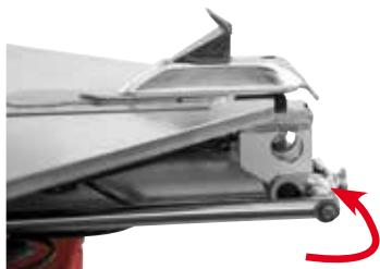
**IT** Regolazione manuale delle griffe per bloccaggio da 24" a 26" **EN** Manual regulation for wheel clamping lock from 24" to 26" **FR** Réglage manuel des mors pour le blocage de 24" à 26"
