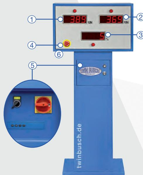
**Einzelproduktübersicht** > Rollen-Bremsenprüfstand (TWB-RS304WD)
