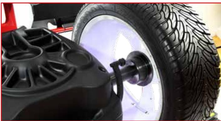
**IT** Illuminazione led per posizionamento tastatore e applicazione pesi.
